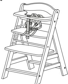
**D** Wird das Produkt in der Konfiguration als Kinderhochstuhl mit einem horizontalen Bauteil (Ablage/Bügel) genutzt, muss zusätzlich zum Schrittgurt, der bei der Erst-Montage dauerhaft zwischen Sitzelement und dem Tisch befestigt werden muss, auch noch der mitgelieferte 5-Punkt-Gurt verwendet werden. Nur die Kombination aus Schrittgurt (passives Rückhaltesystem) und 5-Punkt-Gurt (aktives Rückhaltesystem) gewährleistet die Produktsicherheit bezüglich Herausfallen aus dem Hochstuhl.
